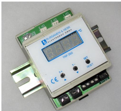
Der Temperaturregler TRP 260 mit Microcontroller wurde für die speziellen Anforderungen von Peltiermodulen entwickelt:
